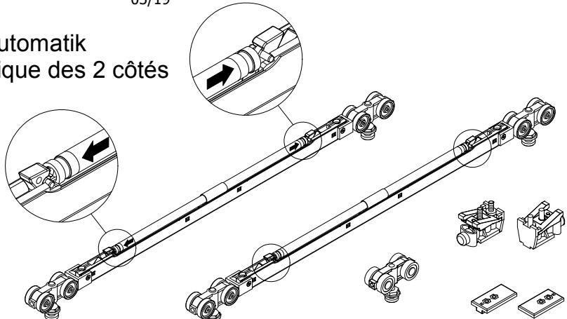
Die Einzugsautomatik muss in beiden Richtungen gespannt sein
