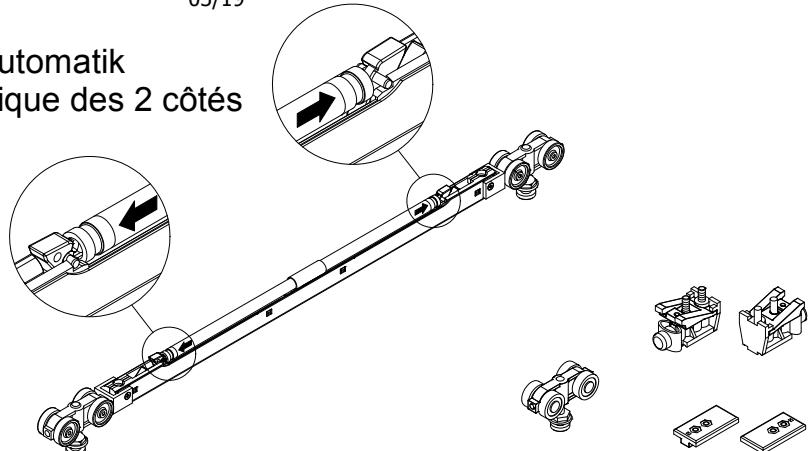
Die Einzugsautomatik muss in beiden Richtungen gespannt sein
